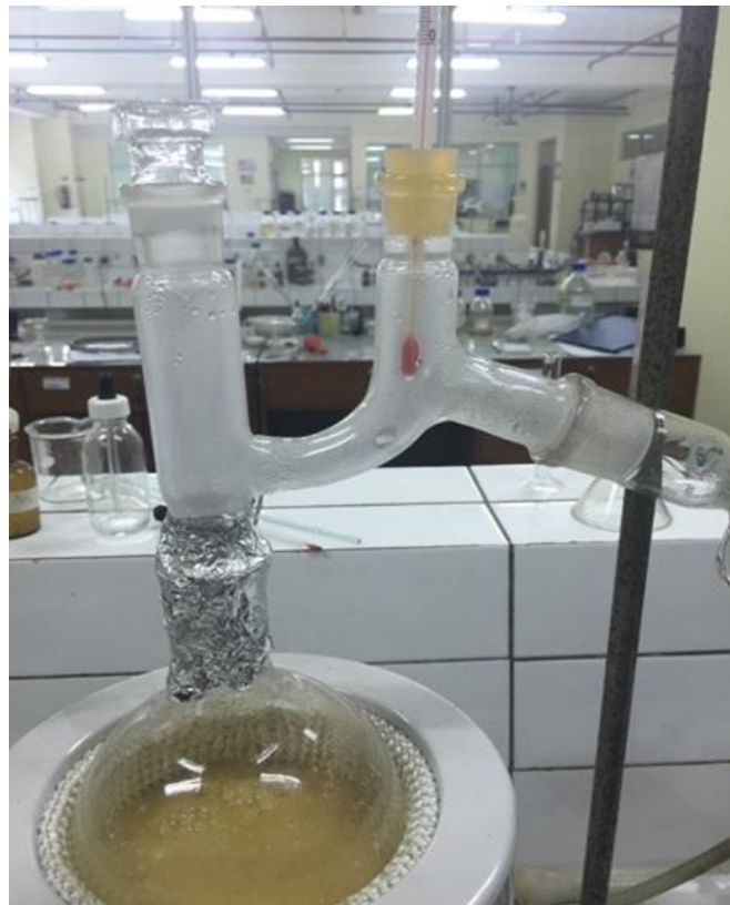
Gambar 7 Proses Distilasi Substrat Kulit Nanas menjadi Bioetanol (Sumber foto: koleksi pribadi)
