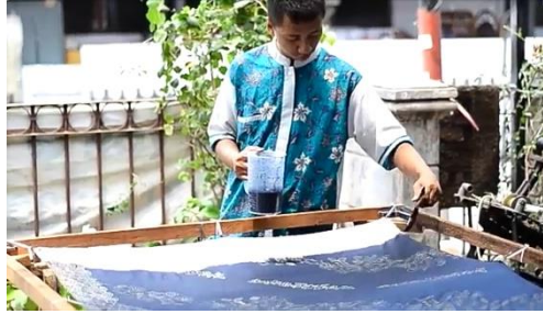
Gambar 7 Proses Pemberian Waterglas atau dimatikan warnanya
