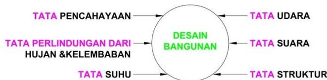
Gambar 11. Diagram penataan atau desain bangunan
